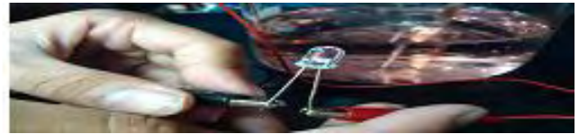
<用鎂—銅金屬電極組合使 LED 燈泡發亮了>
