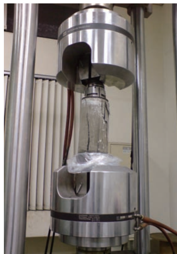
正在進行抗壓強度測試的混凝土樣品
