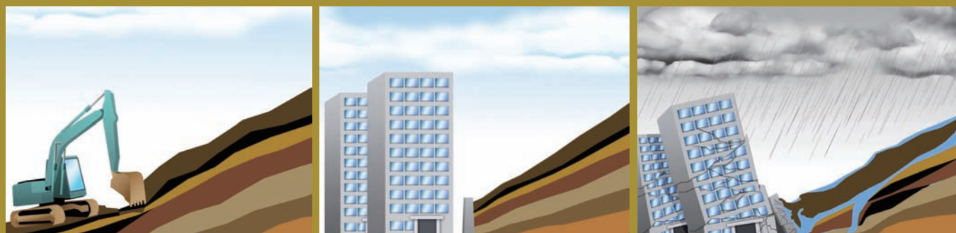
挖除順向坡的坡腳興建擋土牆，容易在地震及豪雨發生時崩塌危及建築物。
