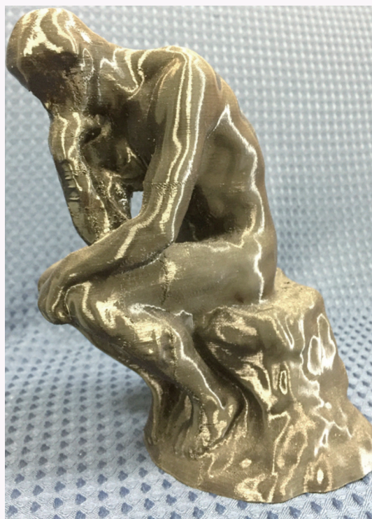
使用熱熔融沉積型 3D 列印機製造出來的羅丹〈沉思者〉雕塑，列印材質是聚乳酸。（列印檔案：MIT CSAIL 資料庫）
