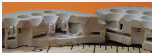
3D 列印的一體成形陶瓷引擎內加熱噴嘴陣列。下圖的剖面顯露複雜的內流道結構，是減法製程以及傳統的成形技術無法製造的。
