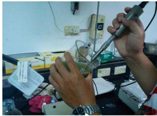
圖 6 超音波粉碎機破壞藻類細胞壁(2)
