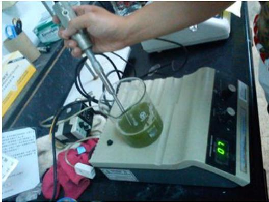
圖 5 超音波粉碎機破壞藻類細胞壁(1)
