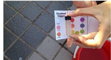
(ii) 將 2 顆溶氧測試錠 TesTabs (DO 字樣) 輕輕置入試管中，隨即旋緊試管蓋，並確定試管中無氣泡殘留在內。
