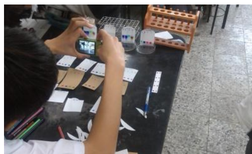
圖 4：色筆點上不同紙材（上）、置入不同展開液（中）和用影像記錄結果（下）
