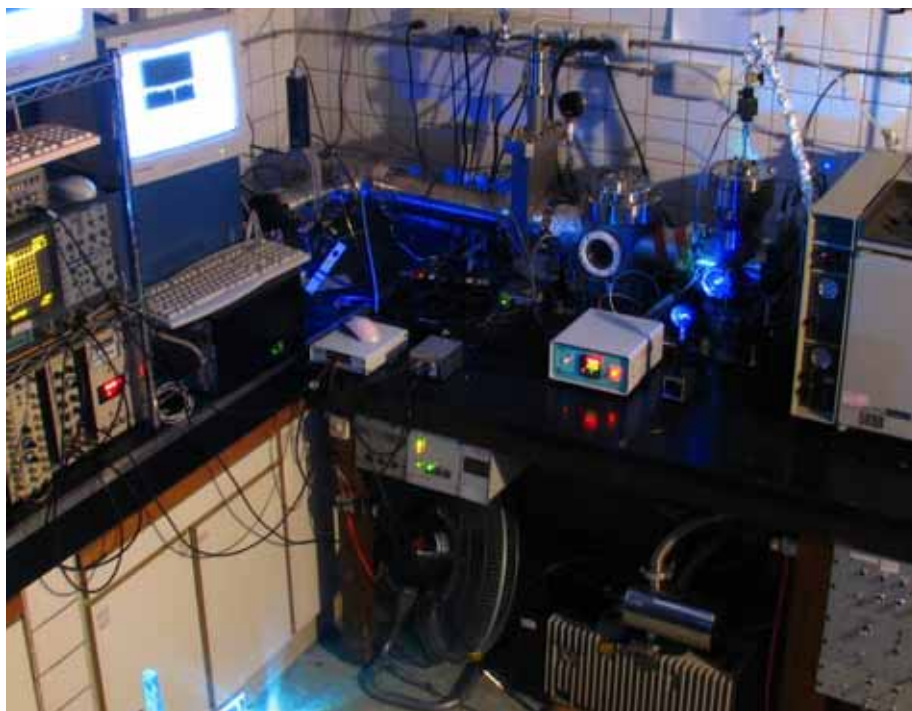
圖 3-1 為本實驗室自組裝的飛行時間質譜儀裝置圖
