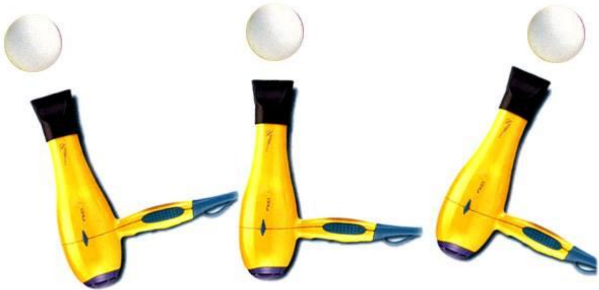
圖二:吹風機與乒乓球實驗示意圖
