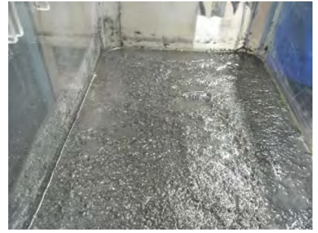
圖十六、以搖擺爐模擬不同震程 gal 值進行搖擺直到表層超過一半以上面積溢出水份視為達到土壤液化
