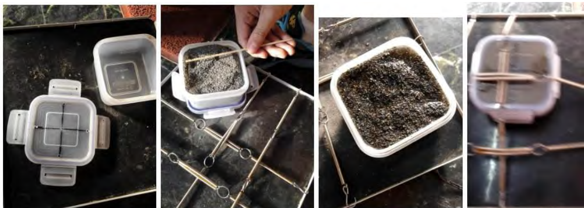
圖 18-1、在飽和土壤經震盪後產生土壤液化現象的噴砂實驗
