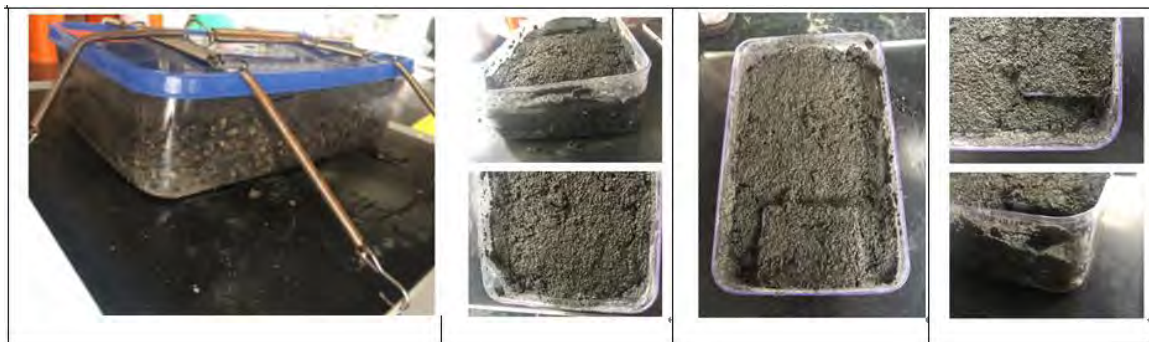
圖 17、震盪後不同土質地形的側潰狀況
