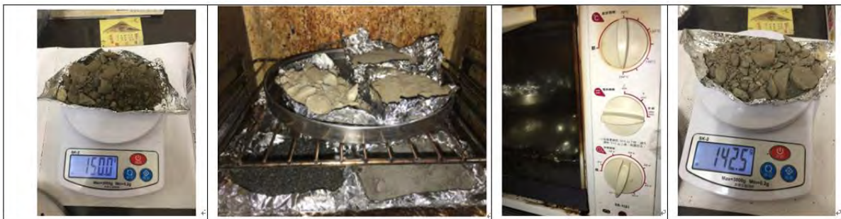
圖 8 烘烤土壤 :由左至右依序為烤前土秤重、將土烘烤、烤溫 150°C、烤後土秤重
