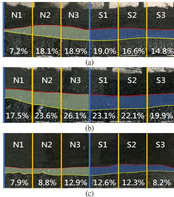
▲ 圖九、無離岸堤模擬實驗侵蝕面積結果。(a、b、c 各為三次實驗結果)
