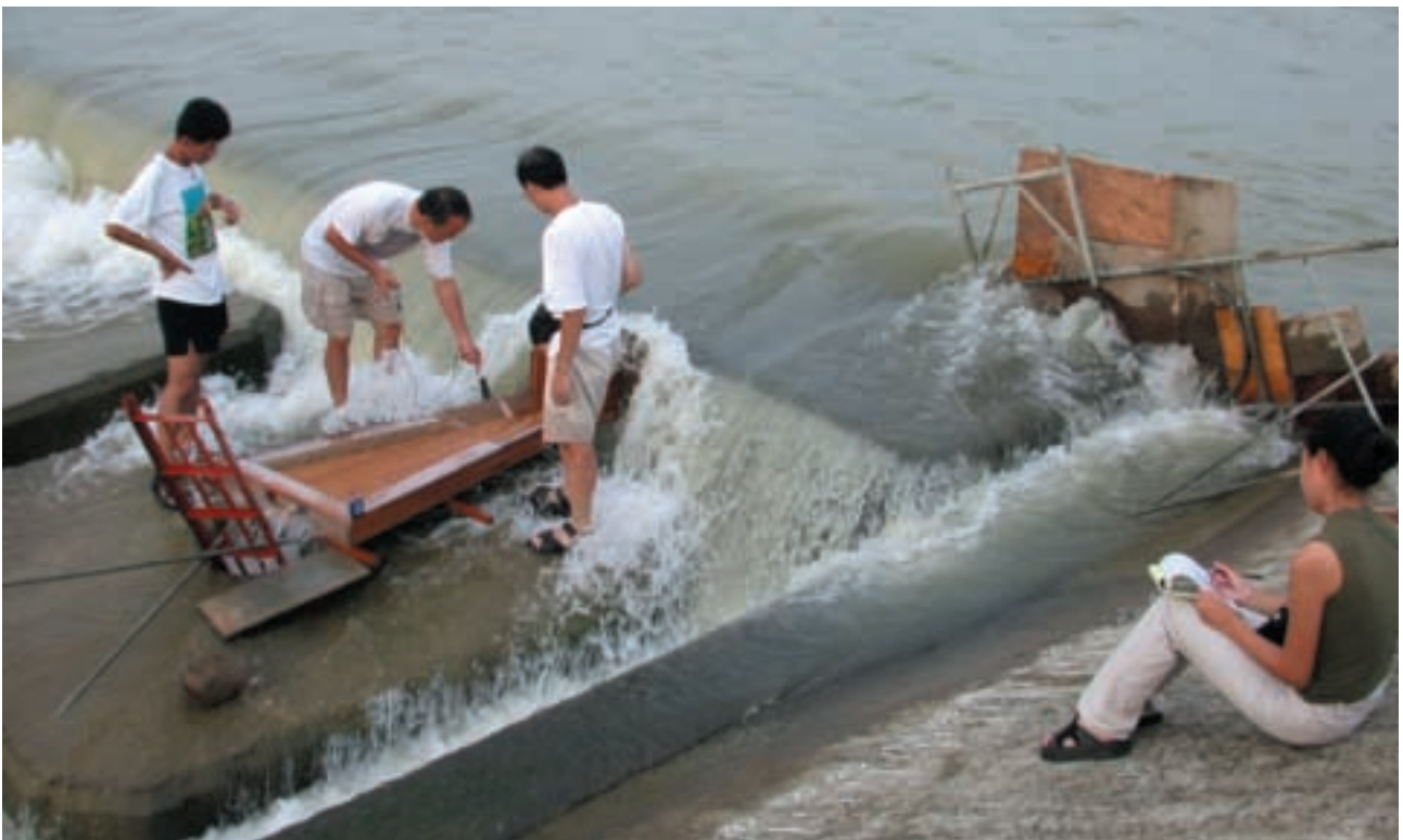
藉由毛蟹溯河能力的實驗，可以知道毛蟹上溯時適合的流速。
