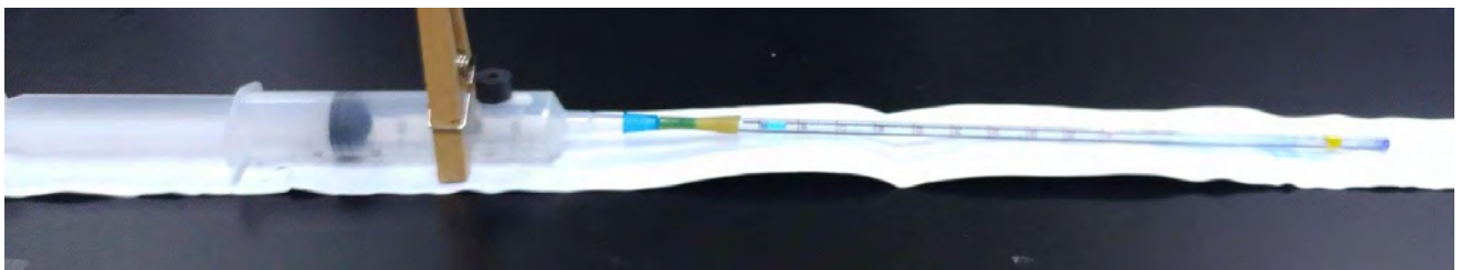
圖十三 脂肪體觸酶活性測量系統之示意圖與照片。
