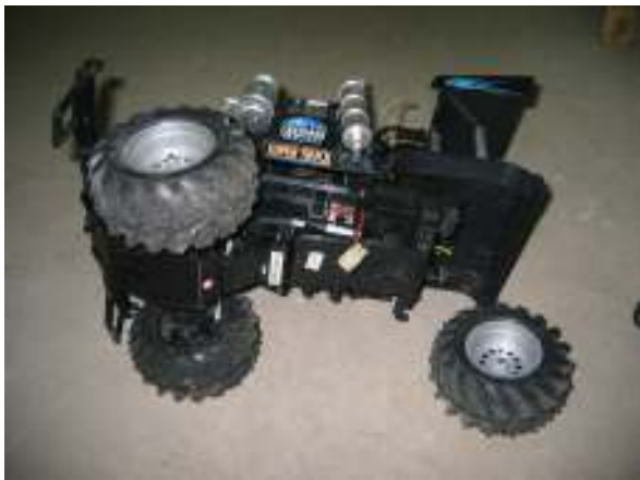
將遙控汽車的馬達拆下當作動力來源。
