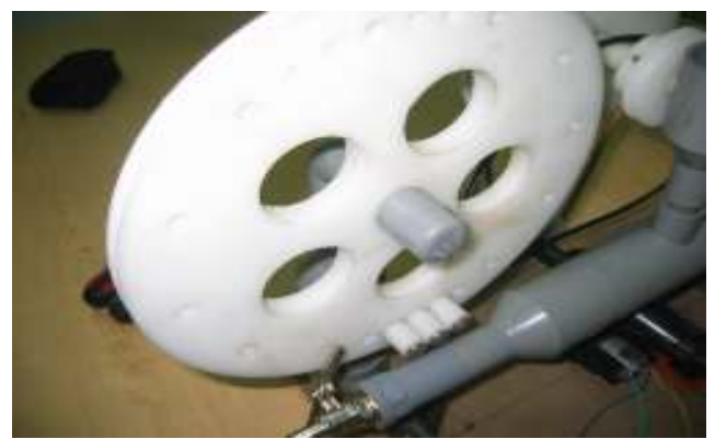
把大輪盤接在水管上，利用大輪盤的凸軸敲擊開關。
