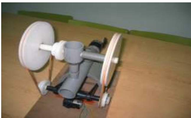
利用皮帶將小圓盤接上大圓盤，使轉速慢四倍。
