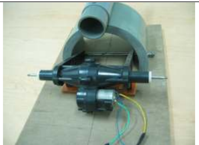
圖為遙控汽車的馬達及後輪動力軸
