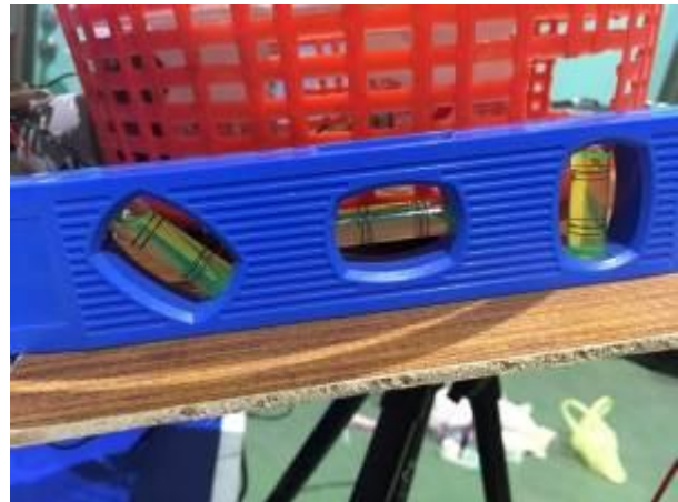
利用水平儀確認前傾的角度
