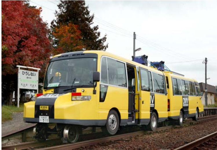
圖 5-1 日本國北海道旅客鐵道株式會社鐵公路兩用車 資料來源：廣田尚敬攝影，《レイルマガジン》(Rail Magazine) 第 268 號 (2005)，取自「編集長敬白アーカイブ」網誌。
