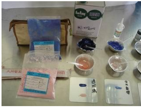
43°C 藍色感溫粉、22°C 紅色感溫粉及保利龍膠、透明漆等感溫粉混和液
