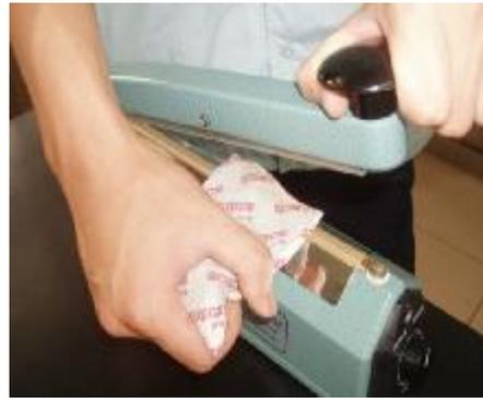
(二) 把自製暖暖包各種配方放入包裝袋中，再用封口機密合(如上右圖)即完成自製成品。
