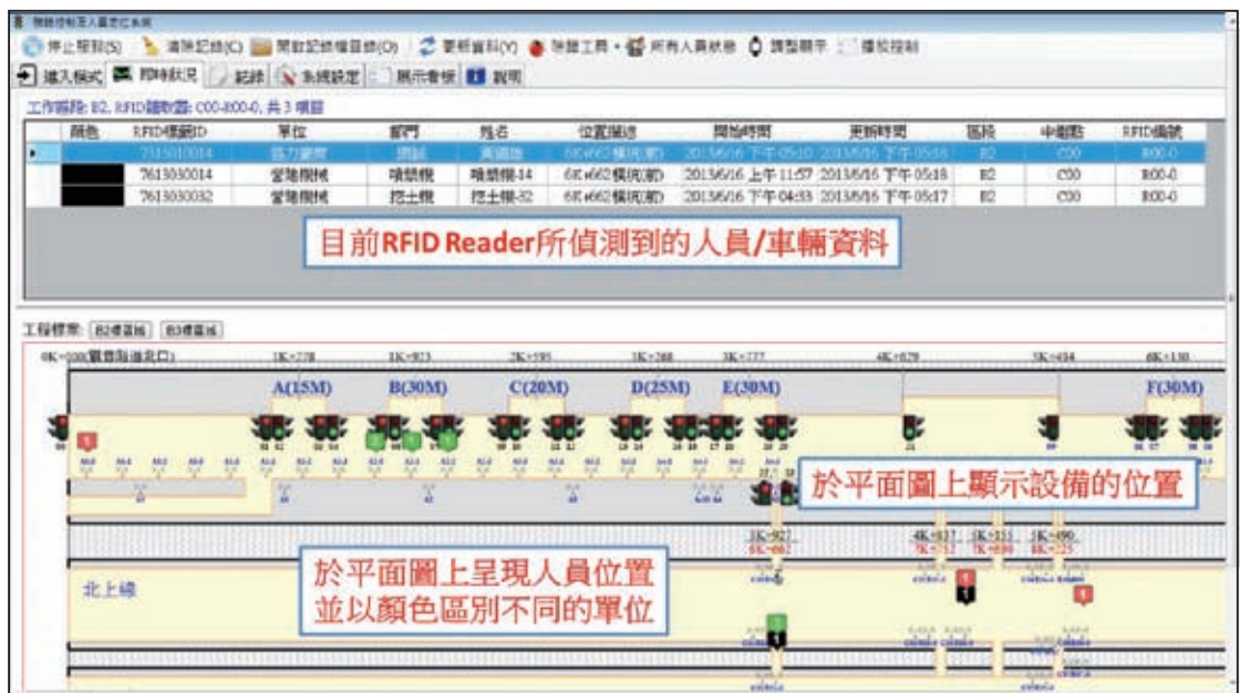
圖5 RFID人車定位及號誌控制系統
