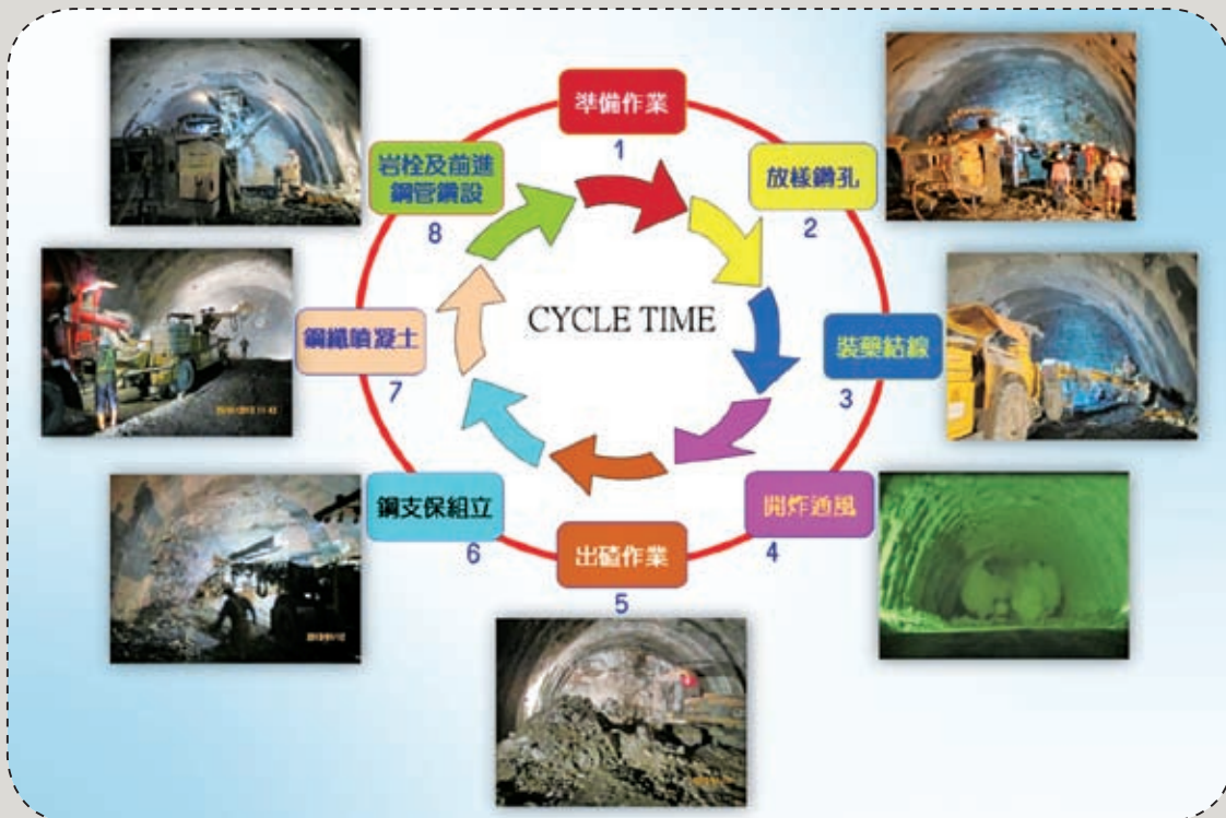
圖4 隧道鑽炸法開挖作業流程圖
