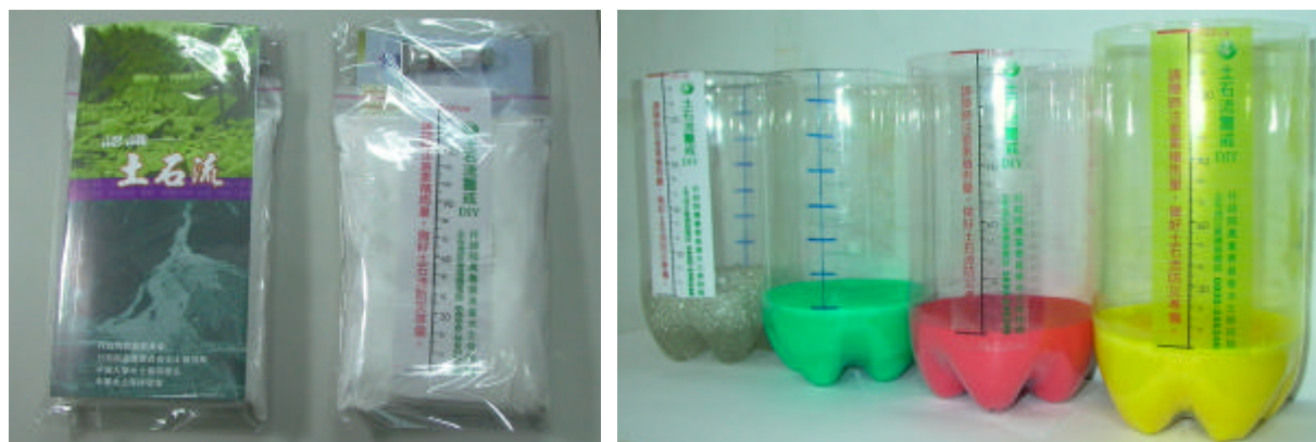
圖 2.18 簡易雨量筒材料包與完成品
