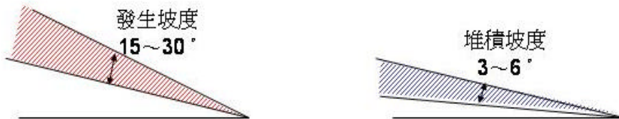
圖 1.4 土石流發生與堆積坡度
