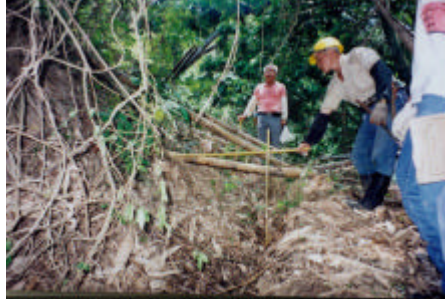
圖 2.45 裂縫搜尋及量測
