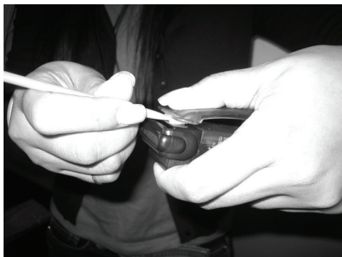
圖七(A)、吸管放在電熱絲上後，兩手指輕壓封口機
