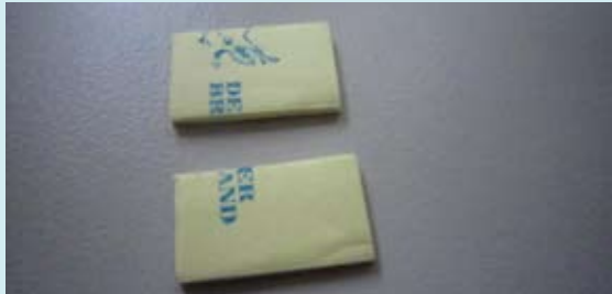
(6A) 取出2片長寬約1cm×1.5cm之泡棉雙面膠。
