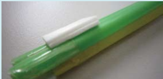
(6C) 將疊合黏貼後之泡棉雙面膠黏至主體艙部之側管下方，位置如上圖所示。
