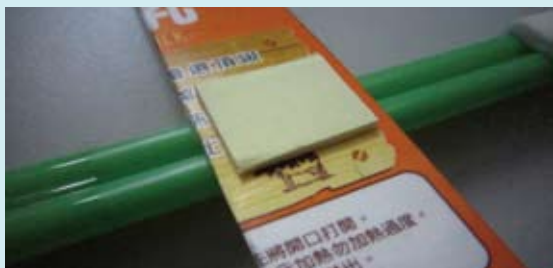
(7E) 將翼板底側中央短邊再黏貼上泡棉雙面膠帶。
