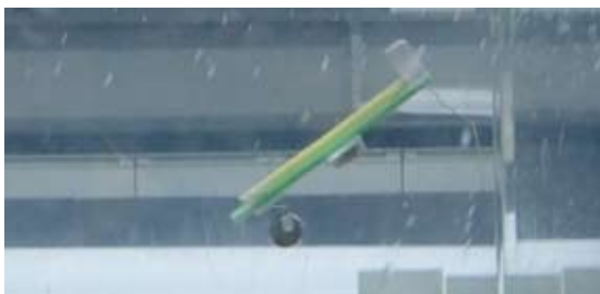
圖(17) 第二階段：水下滑翔機正逐漸下潛、前進並輕碰水槽底部而拋棄配重。
