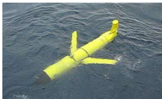
圖(1B) 正在海上進行測試的Slocum Glider。(圖片提供：臺灣大學郭振華教授)
