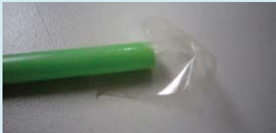
(4A) 將吸管二側各以透明膠帶分別加以封口，並確保其不致進水。
