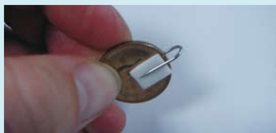
圖(9) 利用尖嘴鉗將大頭針(或3cm細短鐵絲)彎成U字型。
