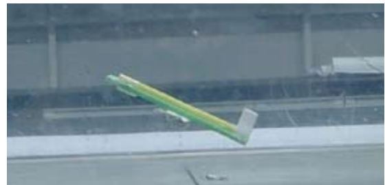
圖(19) 第四階段：水下滑翔機逐漸往上升並同時前進。
