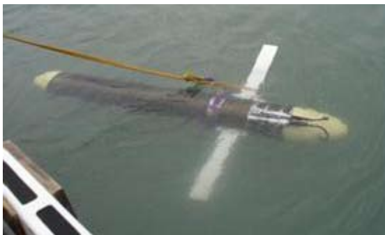
圖(1C) 臺灣大學研究團隊所研發之水下滑翔機。(圖片提供：臺灣大學郭振華教授)
