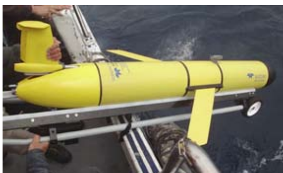
圖(1A) 在研究船舷邊，正預備部署到海上執行監測任務之Slocum Glider。(圖片提供：臺灣大學郭振華教授)
