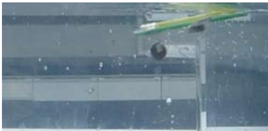
圖(16) 第一階段：將水下滑翔機輕放入透明水槽中之水面上並放開手。
