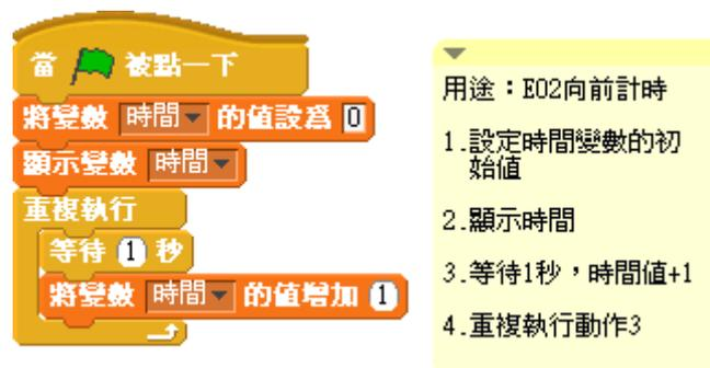
圖 3 Scratch 程式模組範例-E02 向前計時
