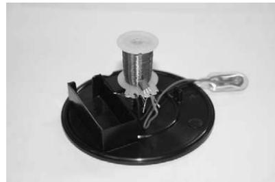
圖 11：粗細漆包線纏繞的漆包線，中心為鐵心
