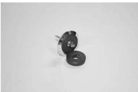
圖13：有N-S磁極之磁鐵與以其為主之塑膠旋轉軸可旋轉之陀螺成品
