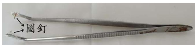
(2)利用攝子夾住陀螺找到陀螺轉軸水平時的支點，再用雷射筆來估測出陀螺重心位置到球心的距離。
