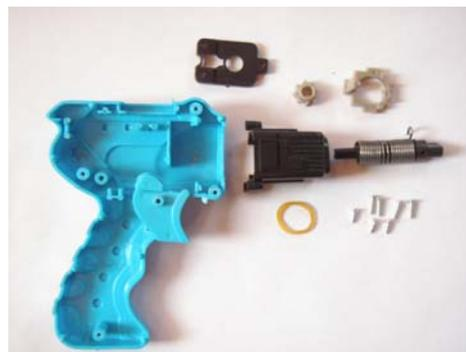
2、裝入馬達(轉速為25000rpm)，把發射槍的轉頭有用的部位切割下來，裝在馬達的轉軸，改裝成為電動發射器。
