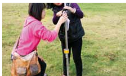
長谷川式土壤貫入測試儀
