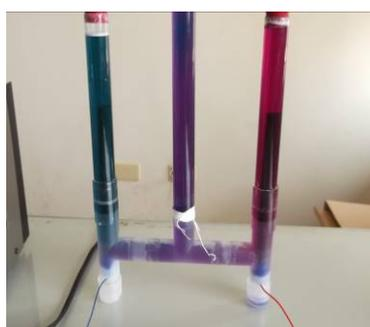
圖 3.2e 電解時的顏色變化
