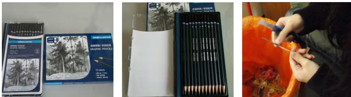
圖 2.5b 將同品牌的筆細心地削去木質取得筆芯
