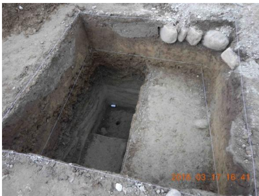
圖 14：坑底鑽探位置
