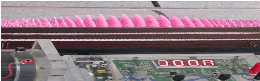
圖 6-5-1  $f=380\text{Hz}$  波漣間距與高度
