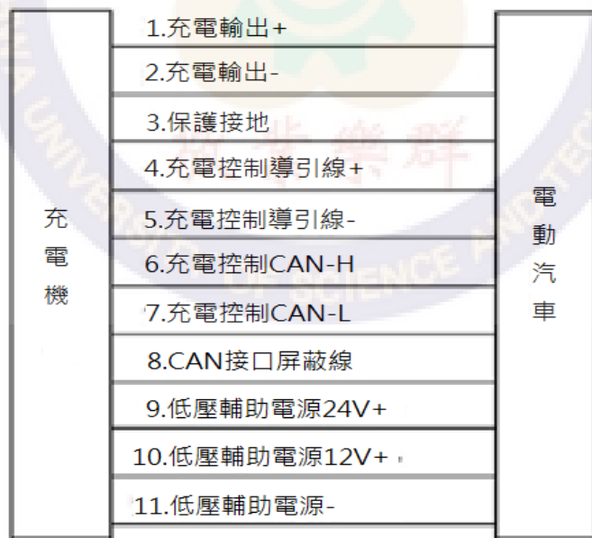
圖4.33 充電機與電動汽車蓄電池系統連接[44]
