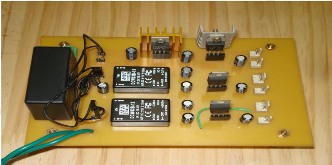
圖 5.3 電源電路板實體圖
