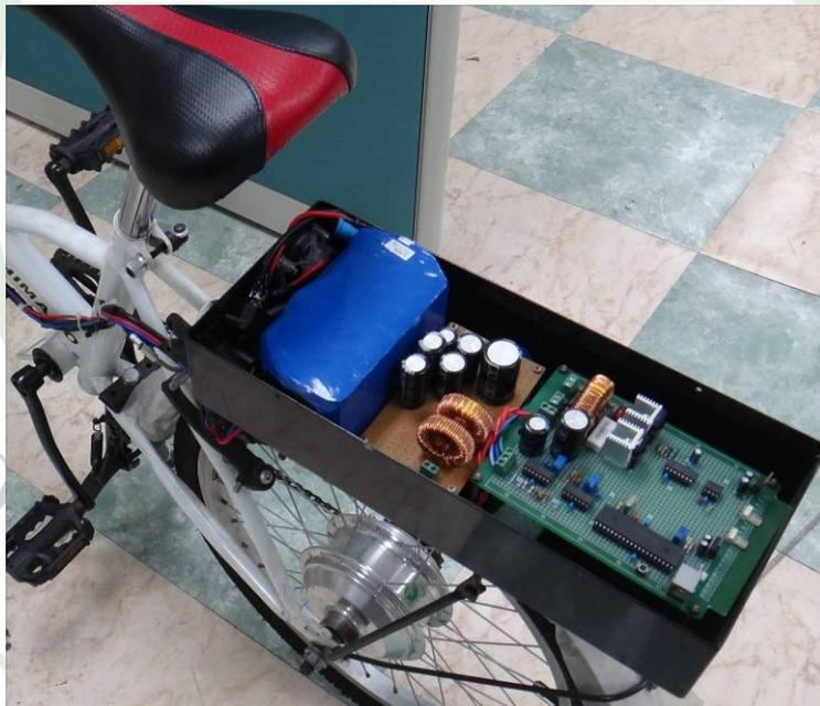
圖 6.7 電源驅動電路板的配置箱
