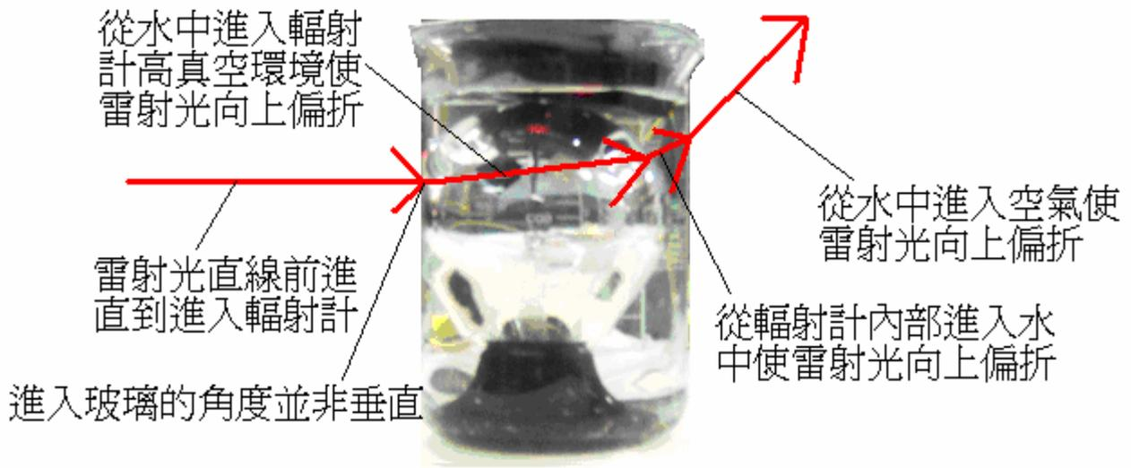
(圖 16)因雷射光會折射，故調整光感應器較高
