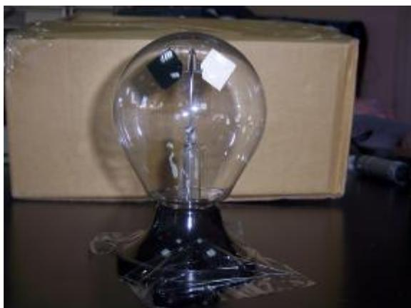
(圖 1)葉輪輻射計(光風車)
