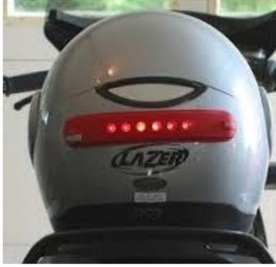
圖 S4.2 安全帽煞車指示燈
