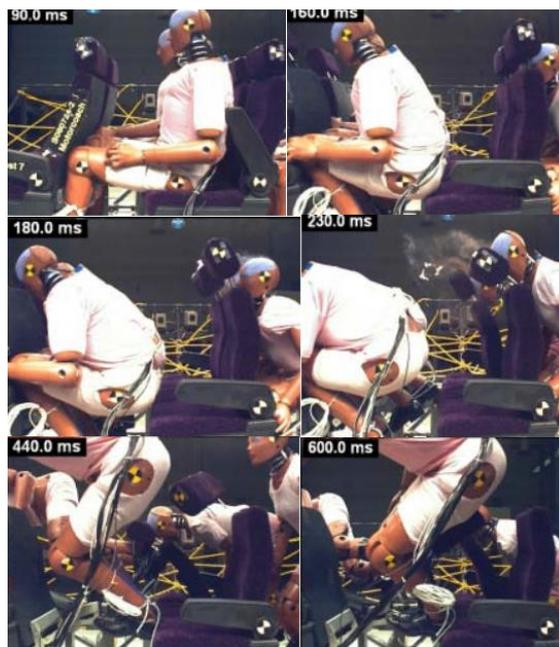
圖 C2.8 未繫安全帶模擬碰撞測試(2)
