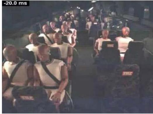
圖 C2.4 使用三點式安全帶碰況模擬(1)
