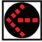
閃紅色箭頭(Flashing steady red)：當工程研究顯示，每一部車輛必須在可左轉通行前完全的停止，則可利用閃紅色箭頭作為控制左轉車輛行為之方法。
