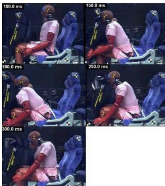
圖 C2.9 使用兩點式安全帶模擬碰撞測試(2)
