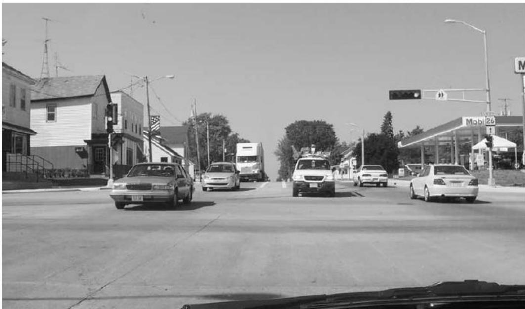
圖 E3.9 由於偏移左轉車道設立所造成的視距變化
