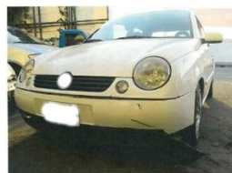
圖 3-5 A 車自小客車車損狀況
