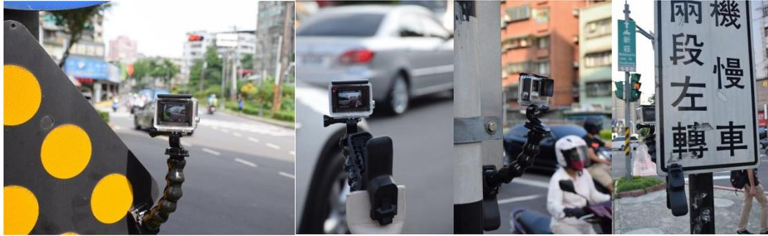
圖 7.10 Gopro 影像機架設示意圖
