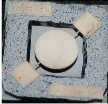
圖 2.4 單軸電磁式微面鏡
