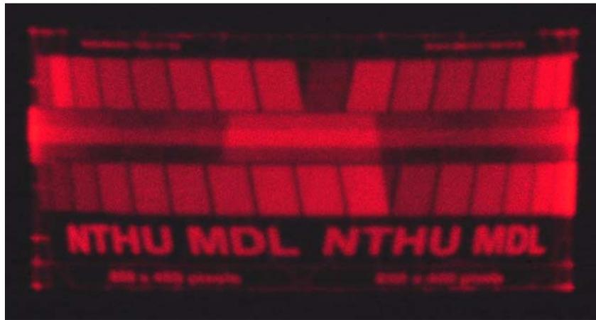
圖B-7 慢軸與快軸操作頻率錯誤之投影結果
