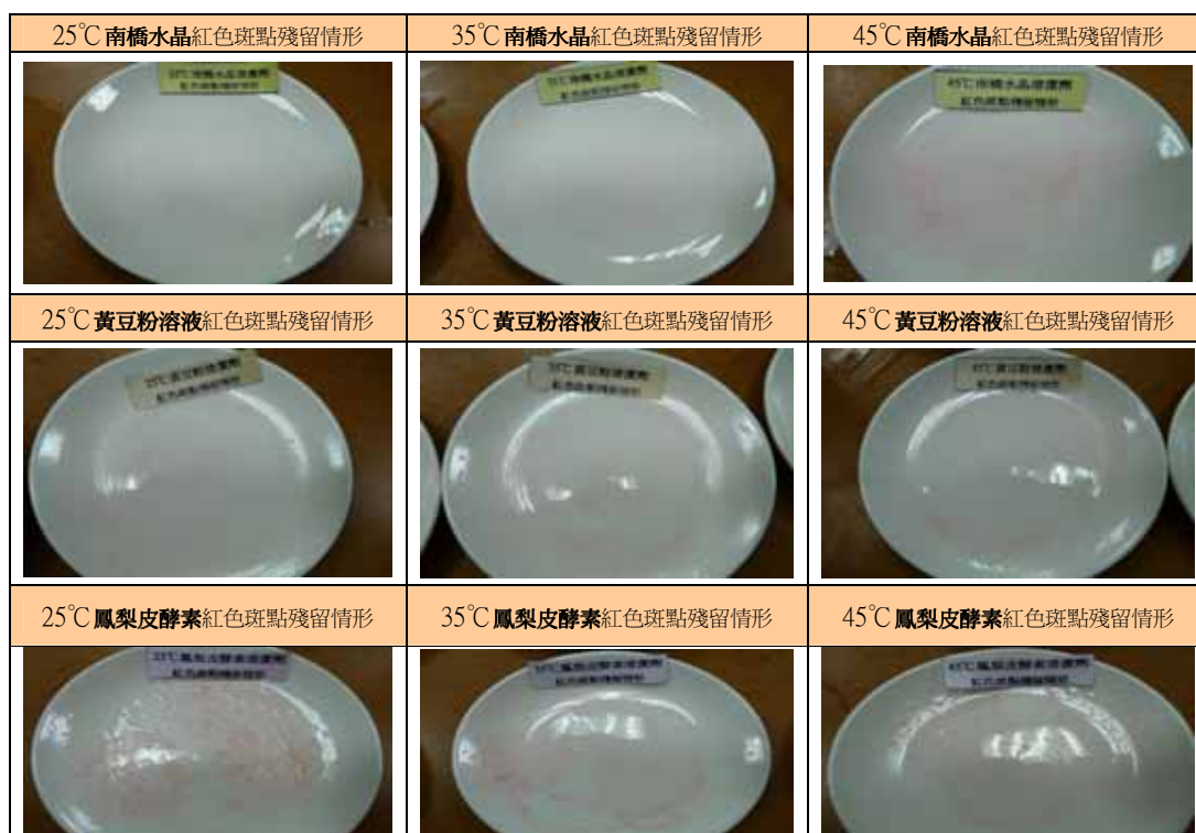
圖八：以蘇丹試劑檢測九種洗潔劑不同溫度的去油力
