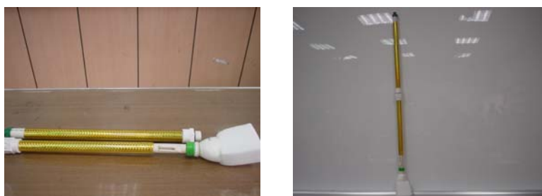
圖 11. 改造水毛筆，控制清潔劑流量
