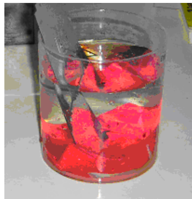
圖七 側面觀察時也是原先銀白色現在反射杯底的紅色
