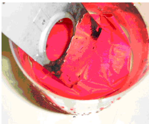
圖六 杯底放紅色色紙後，發現原先銀白色現在反射杯底的紅色。
