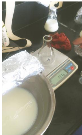
圖二、稱取 200g 脫脂牛奶至殺菌完成之錐形瓶內
