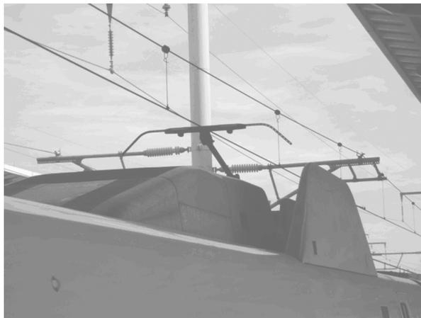
圖 3.1-3 集電弓與集電系統示意圖
