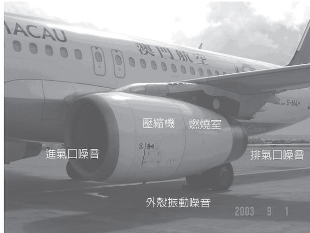
圖 4.1-1 渦輪噴氣引擎示意圖
