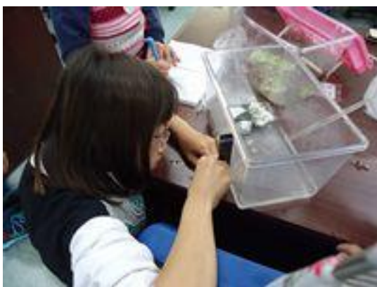
圖 36.測量水箱裡水的高度，確保每次的實驗水位都一樣高
