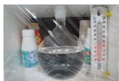
圖十二自製溫度控制瓶 圖十三放入瓶裝冰塊
