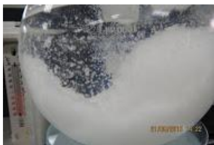
圖十四溫度快速下降的結晶狀況
