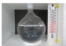
圖十二自製溫度控制瓶 圖十三放入瓶裝冰塊
