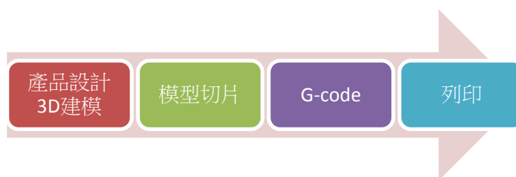
圖表二 3D 列印製程的成型技術流程 4 (註一)
