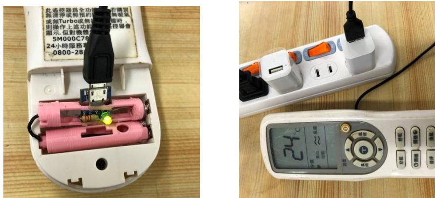
圖 7 冷氣遙控器測試，我們加裝小 LED 做為電源輸入燈
