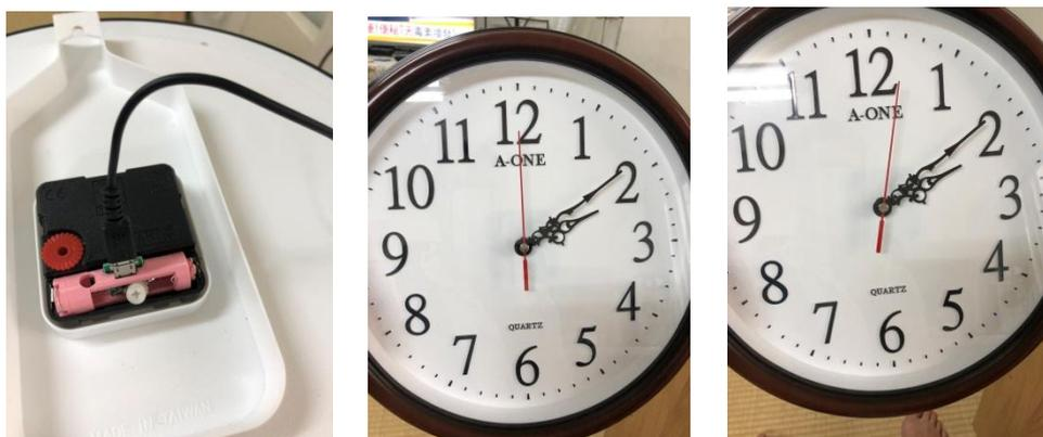
圖 8 家用時鐘測試，我們加裝小型可變電阻做降壓處理
