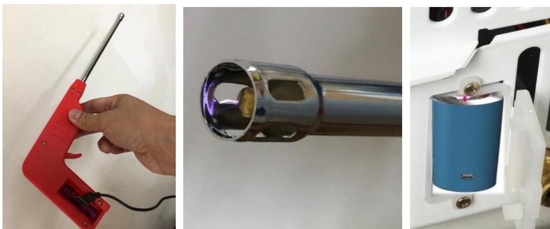
圖 9 家用點火器測試很順利，但熱水器點火則需行動充才能成功
