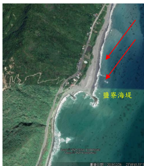
圖 4：鹽寮海堤的人工凸堤效應
