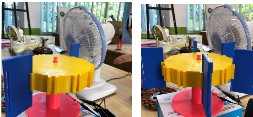
圖 5 單葉片風力發電機之裝置測試，依序增加葉片。
