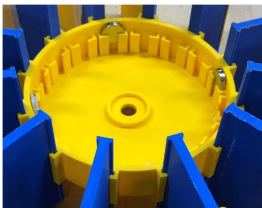
圖 9 不同磁鐵數量與發電機效能測試
