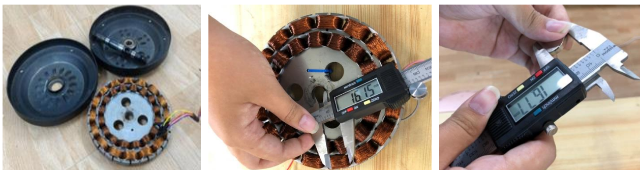
圖 3 我們用游標卡尺精確測量拆解後的吊扇線圈組件及磁鐵尺寸。
