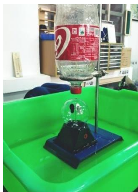
(圖 6)不同溫度的水對於葉片轉速的影響實驗示意圖
